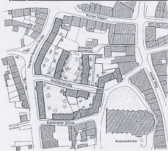
Das stark zerstörte Gebiet westlich des Zentrums mit kleinparzelligen Hausgrundstücken (oben). Der Wiederaufbau ermöglichte eine großzügigere Neugestaltung und eine den Verkehrsverhältnissen angepaßte neue Nord-Süd-Straßenverbindung (unten), verbunden mit einer Fluchtlinienverlegung. (Abb. nach Fleige, wie Anm. 23, S. 300f.)
