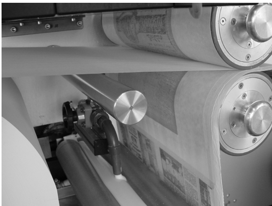
Einfügen des Kernpapiers beim maschinellen Papierspalt- verfahren
